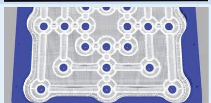
Die einzelnen Oberflächen-segmente einer Step-Datei werden in einem Segment zusammengefasst
