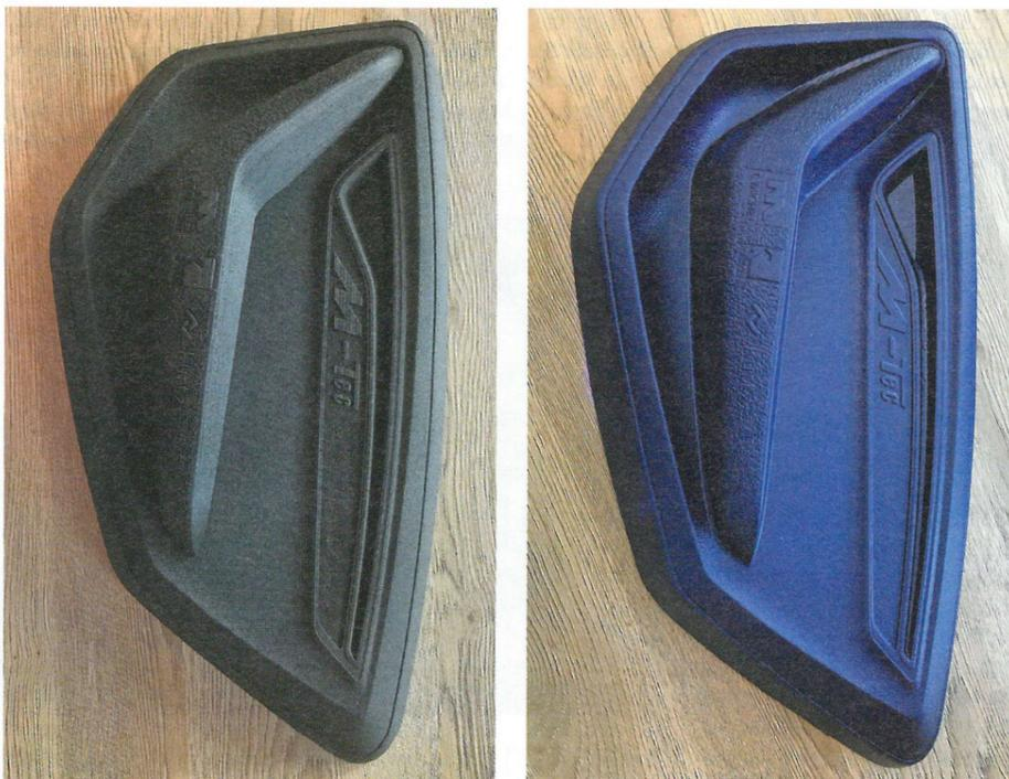
Zweckgemeinschaft – die E-Mobility muss Gewicht sparen, Partikelschäume sind eine Option, etwa bei Türinnenverkleidungen (im Bild zwei Demonstratoren): Am schwarzen Bauteil ist die Laserstruktur zu erkennen, beim blauen Bauteil wurde eine Folie hinterschäumt. Foto: T. Michel
