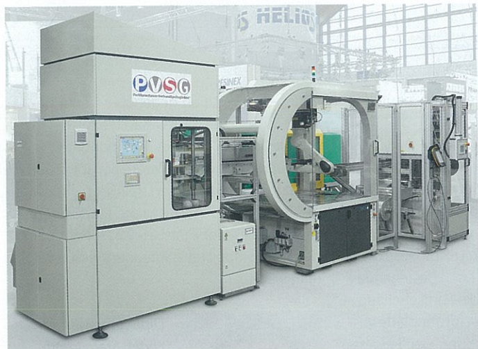
Bild 4. Partikel-schäumautomat mit Spritzgießmaschine und Automations-peripherie, in einer Produktionszelle kombiniert (© Arburg)
